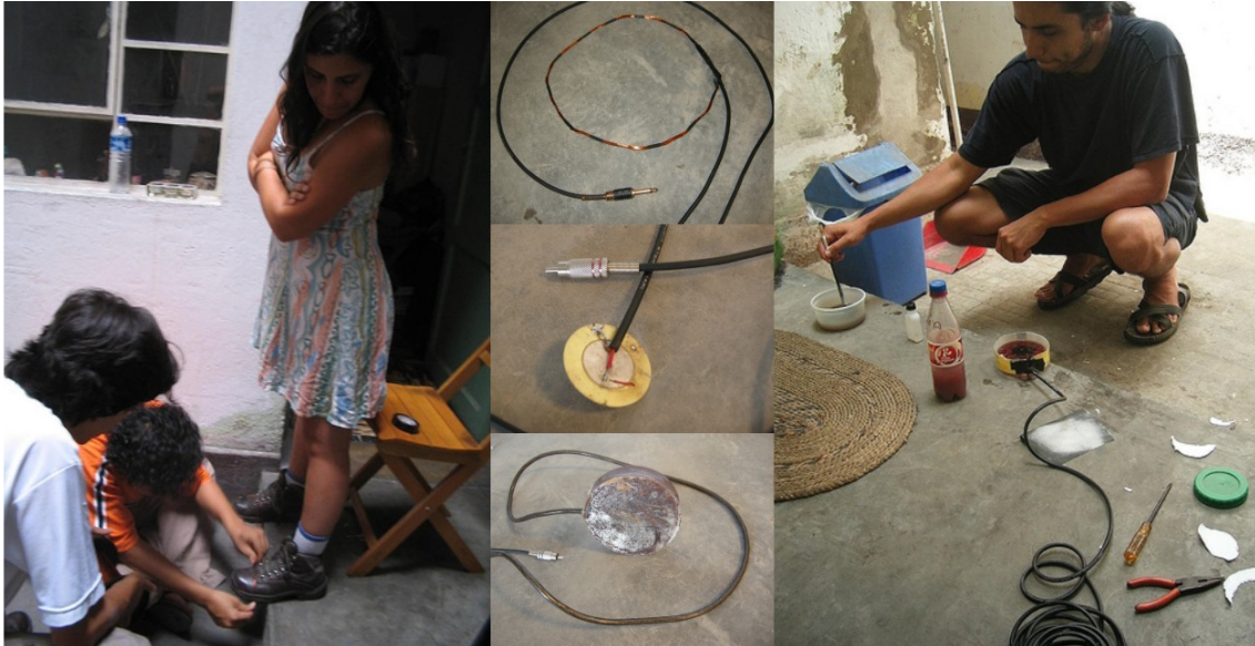
Figura 1: colectivo Aloardi construyendo transductores artesanalmente (sensor electromagnético, micrófonos de contacto, hidrófono).
